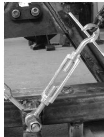
Рисунок 5.2 Фиксация цепи талрепом
